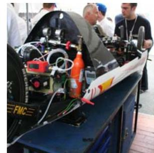
*Vue la chaîne de propulsion électrique du véhicule POLYJOULE*
