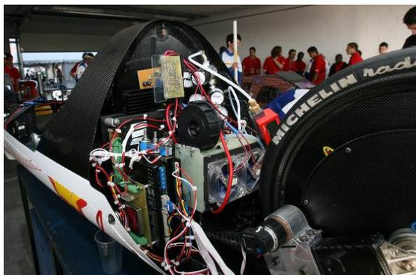
*Système de propulsion du prototype Polyjoule*
