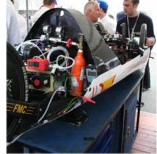
*Vue de la chaîne de propulsion électrique*
